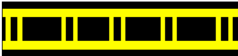
ILS Holding Position Marking
